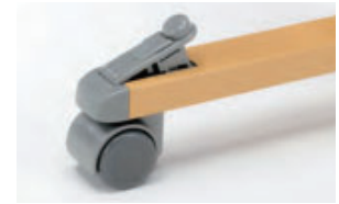
〈ストッパー機能〉 レバーを踏み込むとキャスターを固定
